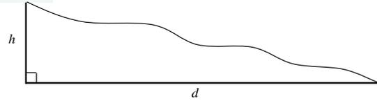
Moteur coupé, un ULM réussit à parcourir une distance horizontale maximale  $d = 1\,200$  m en planant, pour rejoindre un terrain d'atterrissage. Dans ce cas, la finesse vaut  $f = \frac{1\,200}{h}$ .
