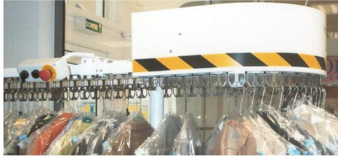
Le convoyeur possède 450 chariots répartis sur une boucle de longueur 27 m. Pour déterminer la vitesse moyenne d'un chariot, on mesure le temps mis par un chariot pour parcourir la boucle complète.
