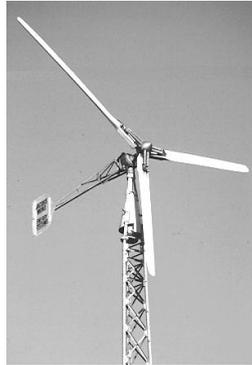
Les pales sont fabriquées en fibre de verre recouverte de résine « époxy » dont un des composants a pour formule brute  $C_8H_{12}O_2$ .
