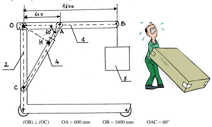
La girafe se compose d'une flèche (1) articulée en O sur un bâti (2). La charge (3) est accrochée en B. L'effort de levage est produit par le vérin hydraulique (4).
