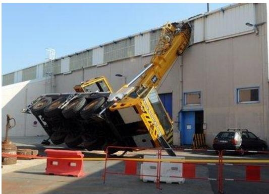
Rupture d'un des vérins de la grue.
