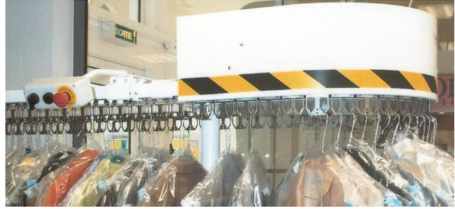
Les vêtements sont suspendus deux par deux sur des petits chariots. Le constructeur du convoyeur recommande de mettre sur un chariot des vêtements de même poids afin d'éviter le blocage du système.
